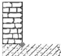
Если фильтрация воды сквозь кирпичную стену несильная, гидроизоляцию кирпичной стены возможно провести Кристаллизолом W12, нанося его шпателем толщиной не менее 5мм.
